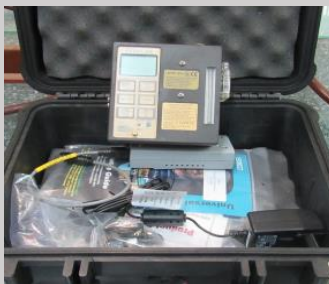
پمپ نمونه برداری فردی دولوکس SKC
