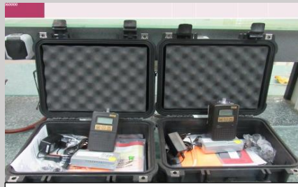
پمپ نمونه برداری فردی airchek
