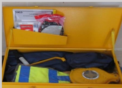
دستگاه تنفسی با دمنده دستی (بلومن)
